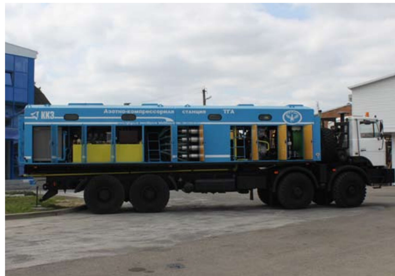
Азотно-компрессорная станция ТГА
