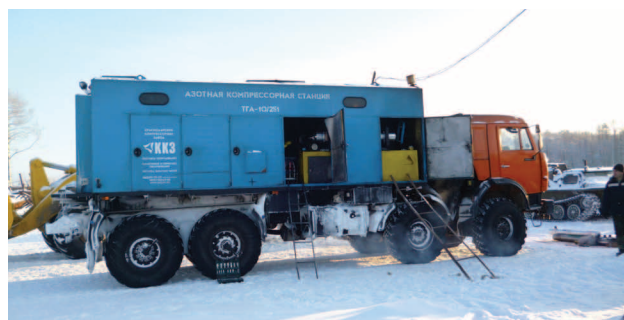
Самоходная азотно-компрессорная станция ТГА на шасси «КаМАЗ»
