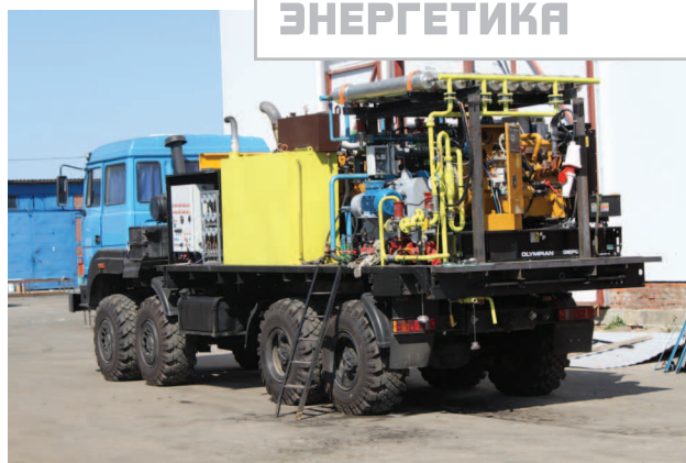
Самоходная азотно-компрессорная станция ТГА на шасси «Урал»
