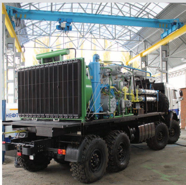
Самоходная азотно-компрессорная станция ТГА на шасси «КамАЗ»
