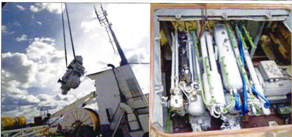
Рисунок 16 – Компрессорная станция 4ВМ2,5-15/151
