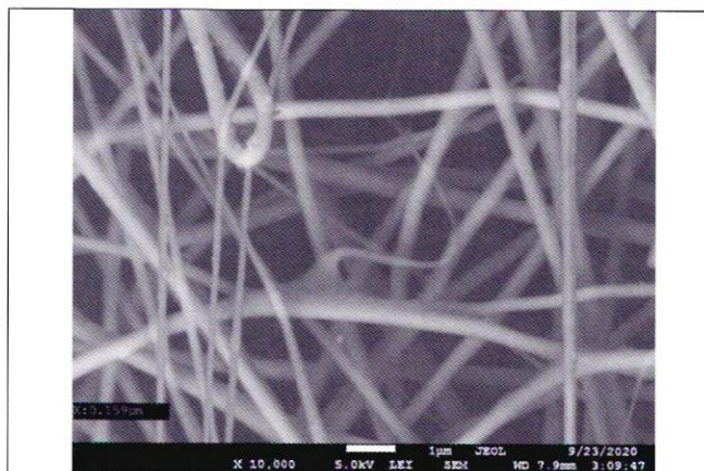
Рисунок 10 – Нано-нити нейлона диаметром 150-400 нанометров
